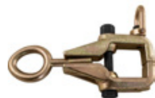
Pinça de chapeiro bi-direcional Capacidade: 2t (transversalmente) 3t (longitudinalmente)
